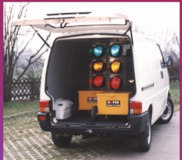
Signalanlage umgeklappt im Transporter
