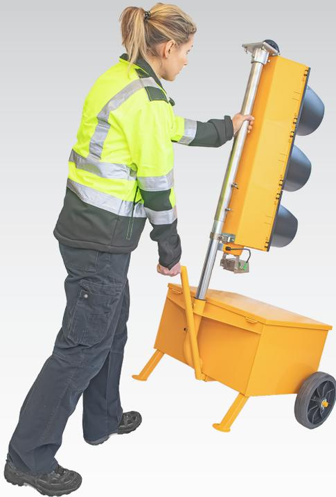
Das stabile Aluminiumguss-Klappsystem ist Bestandteil des Ampelkopfes und ermöglicht den einfachen Transport der Signalanlage ohne diese zerlegen zu müssen. Der Ampelkopf wird einfach umgeklappt und abgesenkt. Alle Anschlüsse bleiben bestehen und die Kabel verlaufen durch ein flexibles Schutzwellrohr. Diese Art des Klappsystems wurde bereits vor vielen Jahrzehnten patentrechtlich geschützt und immer weiter optimiert. Inzwischen werden 99 % unserer Signalanlagen mit Klappsystem verkauft.
