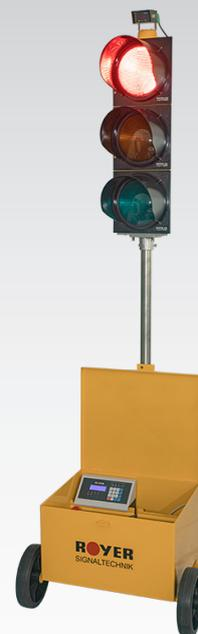
Als Leuchtmittel kommen serienmäßig LED-Module mit Schutzart IP65 und automatischer Helligkeitsanpassung sowie Eco-Modus zum Einsatz. Das Linsensystem bietet ein homogenes Lichtfeld gemäß EN12368, daher sind keine einzelnen LED-Punkte sichtbar.
